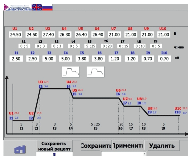
Рис. 1. Программа переплава (рецепт) для сплава ПШРЗ ЭП718
