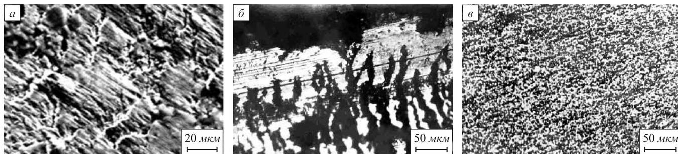
Рис. 1. Изношенные поверхности СВС-композигов составов TiC – Cu – Г13 (а), TiC – Cu – (Co, Ni – Cr) (б) и TiC – Cu – Fe (в) после скольжения под высокими давлениями
