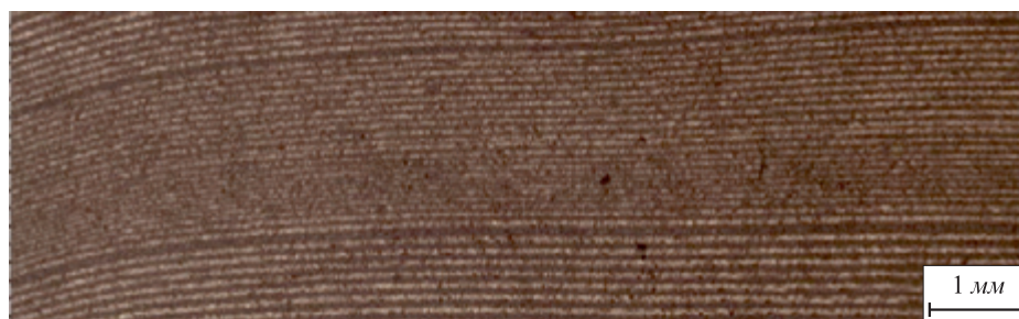
Рис. 1. Микрофотография образца композита ZDI-E до термической обработки
