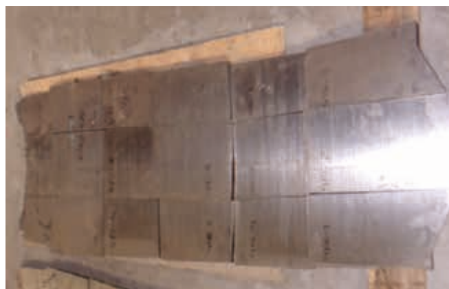
Рис. 4. Макроструктура слитка Inconel 718, разлитого по варианту 2
