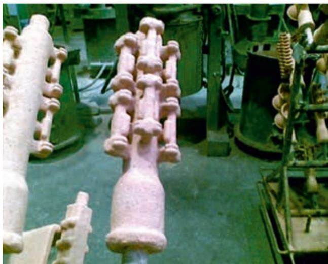
Рис. 1. Модельный блок ЛВМ
