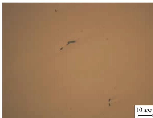
Рис. 2. Сульфиды марганца в непрерывнолитой заготовке рельсовой стали Э76ХФ производства АО «ЕВРАЗ ЗСМК»
