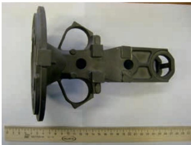
Рис. 4. Отливка «Вилка»
