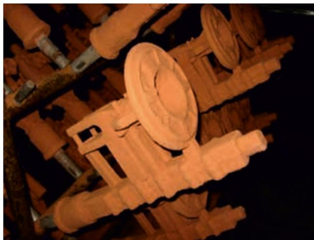
Рис. 3. Модельный блок отливок «Вилка»
