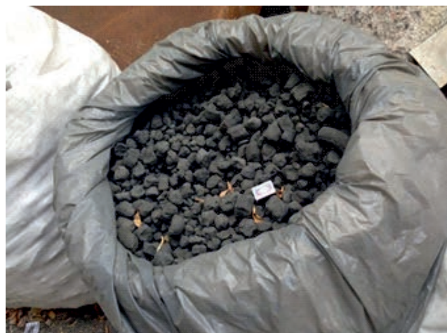
Рис. 2 Начальный внешний вид брикетов из руды и кокса КНР
