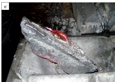
Рис. 2. Общий вид однофазной руднотермической печи (а), состояния колошника (б) и слитка сплава АХС, полученного бесшлаковым способом (в)
