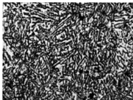
Рис. 3. Микроструктура «сорбит с участками мартенсита»,  $\times 200$
