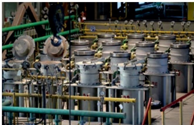
Рис. 5. Промышленные SHS реакторы НТПФ «Эталон»
