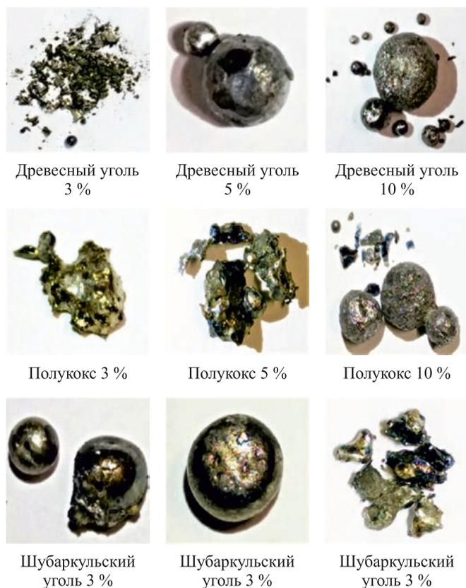
Рис. 2. Внешний вид продуктов восстановления с разными видами и концентрацией восстановителя в брикете
