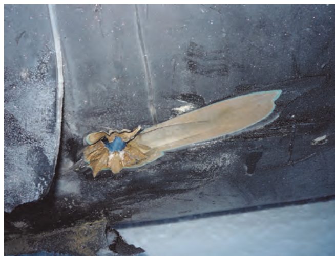
Рис. 3. Раскатной пригар на внешней поверхности трубы
