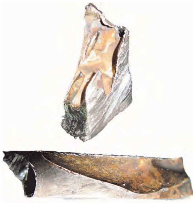
Рис. 5. Образцы дефекта, вырезанные поперечно (вверху) и параллельно (внизу) направлению проката стального листа
