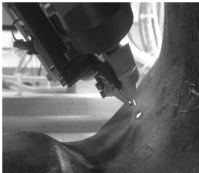
Рис. 3. Лазерное наведение рентгеновских трубок на точку измерения напряжений во фрагменте боковой рамы, вырезанном из зоны буксового проема радиуса R55
