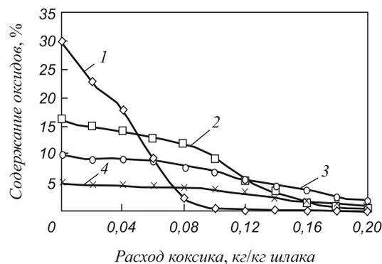
Рис. 1. Зависимость содержания оксидов железа (1), ванадия (2), марганца (3), титана (4) в шлаке от расхода коксика
