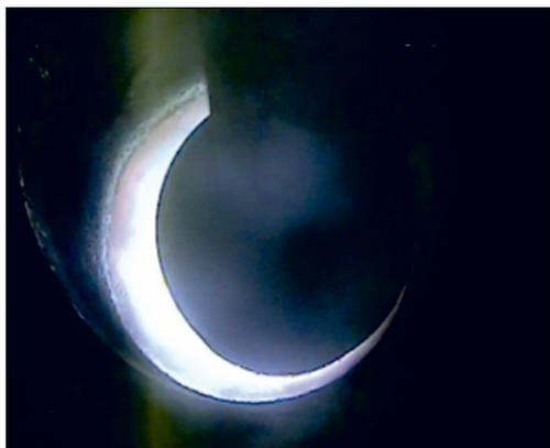
Рис. 4. Короткая электрическая дуга, сильная ионизация
