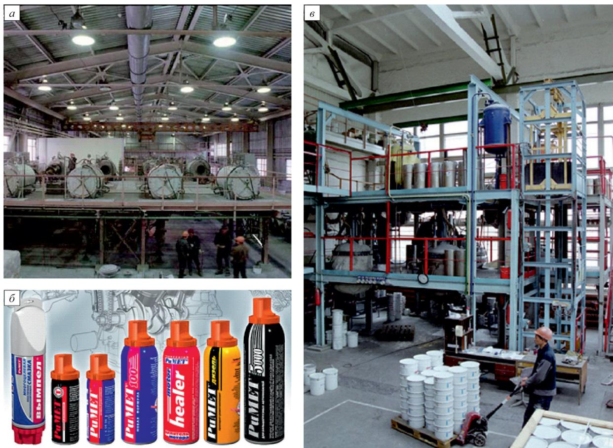
Рис. 5. Производство металлических порошков методом газофазного синтеза и материалов на их основе в ИТЦ «Академический»: а – производство порошка цинка; б – продукция для защиты поверхностей трения на основе бронзового порошка; в – производство цинкнаполненных красок
