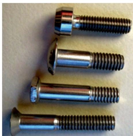
Рис. 2. Болты из высокопрочной (классы прочности 8.8. – 10.9) и коррозионностойкой азотистой стали 05X16H5AB, не склонной к межкристаллитной коррозии, полученные методом холодной высадки на заводском оборудовании (АО «Завод Нормаль», г. Нижний Новгород)
