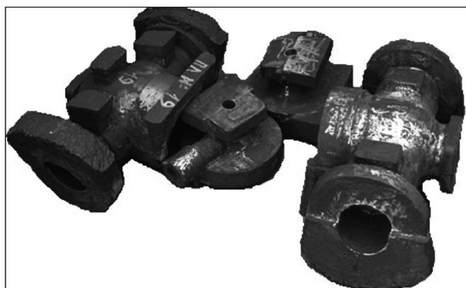
Рис. 1. Литые заготовки для высокопрочной коррозионностойкой запорно-регулирующей арматуры из новой стали 05X21AG15H8MFL:
