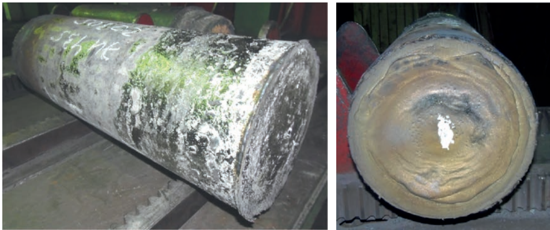
Рис. 1. Слиток ВДП сплава ЭИ435, переплавленный по опытной технологии
