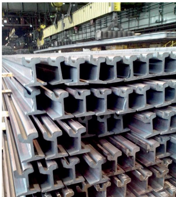
Рис. 5. Опытная партия прокатанных трамвайных рельсов Т62
