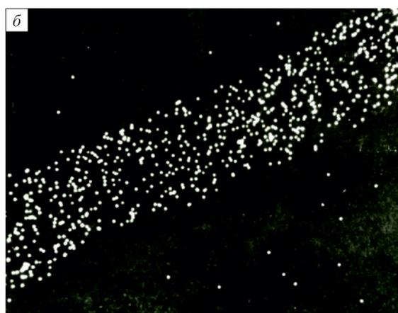
Рис. 3. Микроструктура,  $\times 1000$ , сплава VK10КС с ионно-плазменным покрытием (Ti, Zr)N в характеристических рентгеновских излучениях титана (а), циркония (б)
