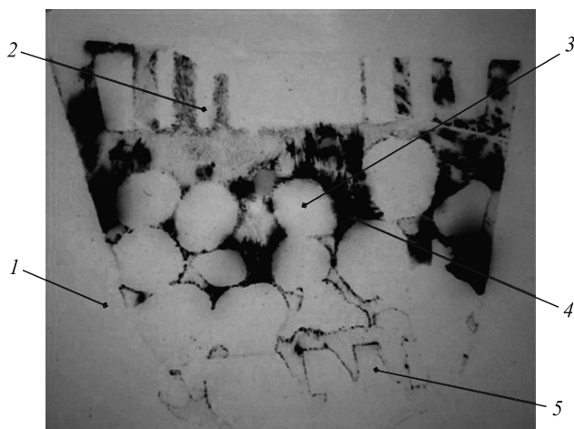
Рис. 2. Серный отпечаток остатка металла в разливочной воронке с зернистым фильтром:
