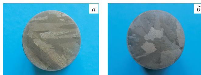
Рис. 1. Макроструктура образцов из стали марки 110Г13Л: а – без НМ; б – НМ 0,025 % TiN
