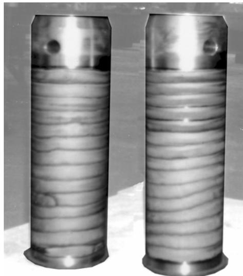
Рис. 7. Пальцы ковша экскаватора с плазменной закалкой
