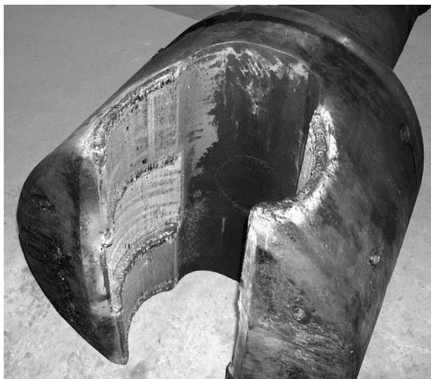
Рис. 6. Универсальный шпиндель прокатного стана с наплавкой
