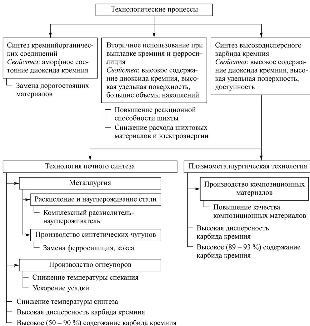
Рис. 1. Использование микрокремнезема в технологических процессах
