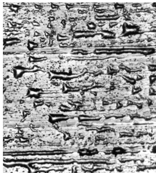
Рис. 1. Микрорельеф на контактной поверхности аморфной ленты сплава на основе железа, \times 400
