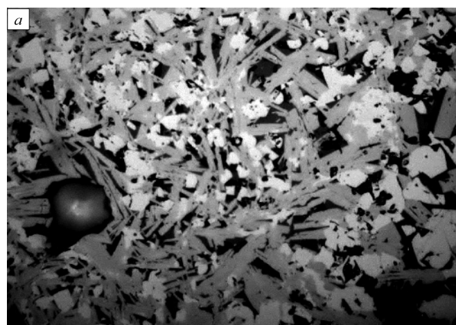
Рис. 5 Микроструктура агломерата с добавкой 3 % НКШ. Ферриты – светлосерые пластинчатые кристаллы, стеклофаза – темносерые. Отраженный свет, \times 500
