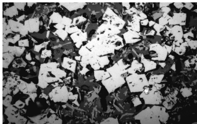
Рис. 4 Микроструктура агломерата с добавкой 1 % НКШ. Стеклофаза – серая, игольчатые кристаллы феррита – светлосерые. Отраженный свет, \times 500
