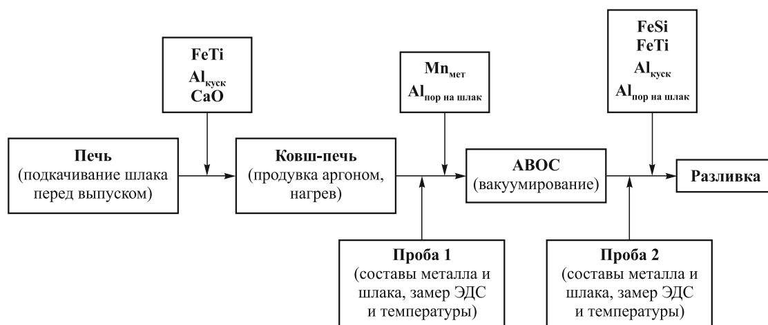
Схема внепечной обработки стали 08X18H10T на заводе «Электросталь»
