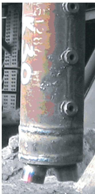
Рис. 1. Конструкция (а) и вид (б) газоохлаждаемой торкрет-гарнисажной фурмы:
