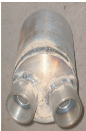
Рис. 2. Конструкция (а) и вид (б) наконечников двухсопловой газопорошковой фурмы:
