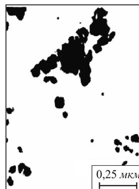
Рис. 2. Микрофотография нанокарбонитрида хрома (ПЭМ)
