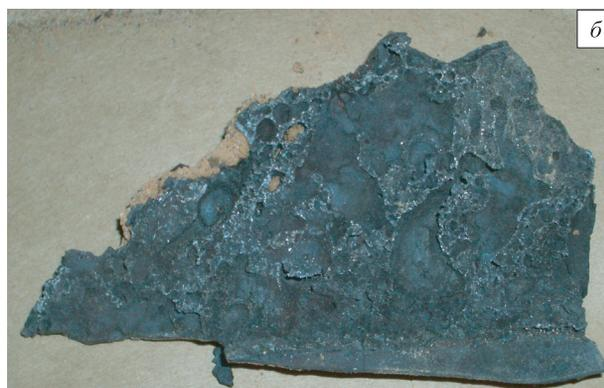
Рис. 4. Окалина после нагрева по второму режиму: а и б – вид образца снаружи и внутри соответственно
