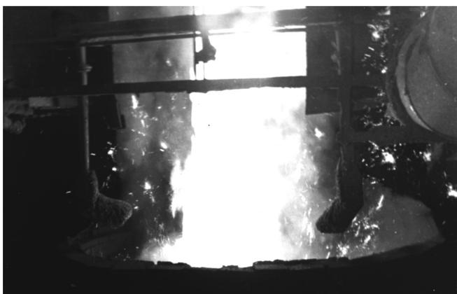
Рис. 1. Перелив чугуна из миксера в ковш с работающей установкой пылеподавления азотом в миксерном отделении кислородно-конвертерного цеха МК «Азовсталь»
