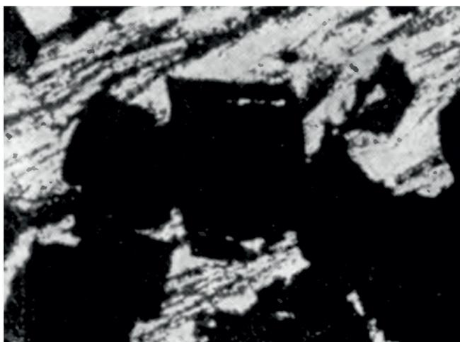
Рис. 1. Кристаллы оливина в агломератах основности 1,2: оливин – светлые кристаллы, магнетит – черные. Проходящий свет, ×500
