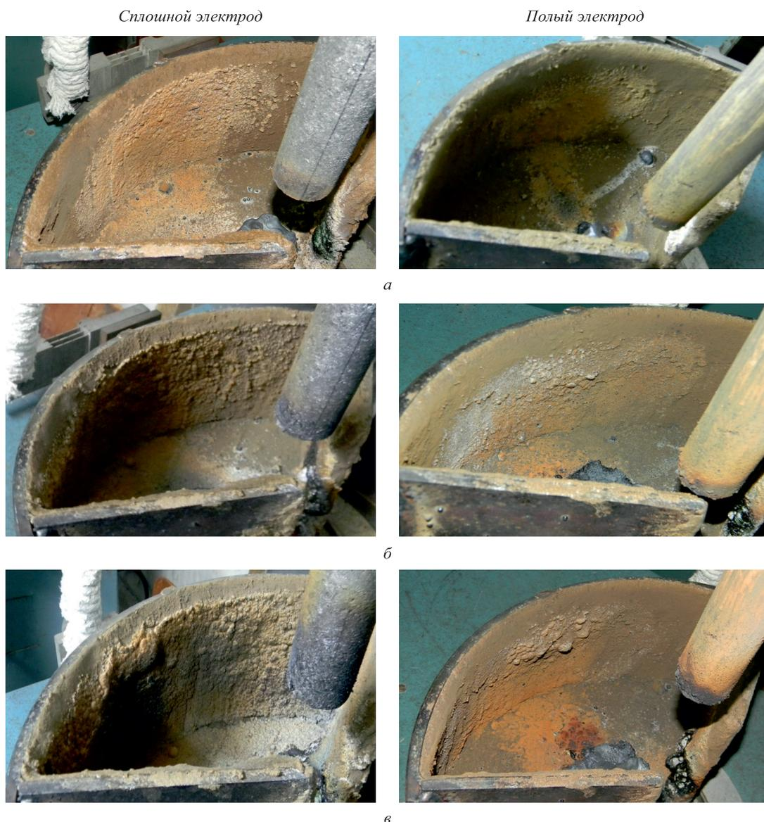
Рис. 5. Снимки разгара футеровки вертикальной боковой стенки экспериментальной установки в ходе проведения эксперимента:
