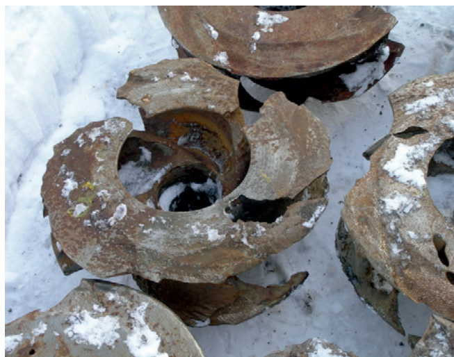
Рис. 1. Характер износа рабочего колеса насоса Гр после проведения рабочего цикла
