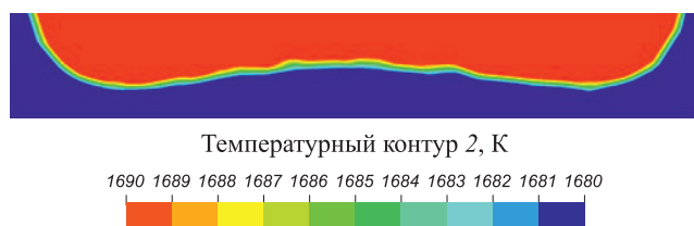
Рис. 3. Форма фронта кристаллизации для скорости вращения 90 об/мин
