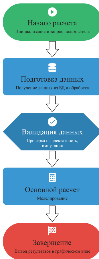
Рис. 1. Основная блок-схема алгоритма расчета наполнения горна доменной печи
