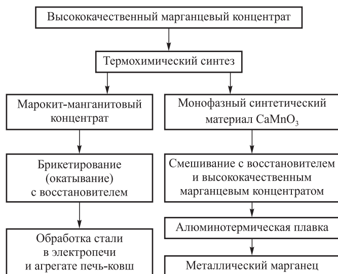
Рис. 4. Технологическая схема применения высококачественного марганцевого концентрата
