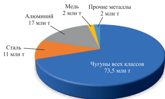
Рис. 6. Структура мирового производства отливок по видам материалов за 2020 г. (по данным журнала Modern Casting [5])
