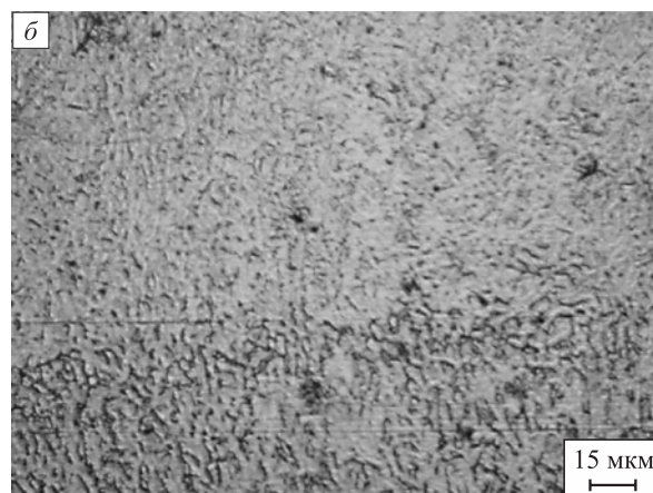
Рис. 5. Структура образца 2, полученного методом SLM: ×200 (а); ×500 (б)
