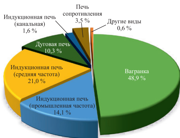
Рис. 10. Распределение литья в Беларуси по методу плавки
