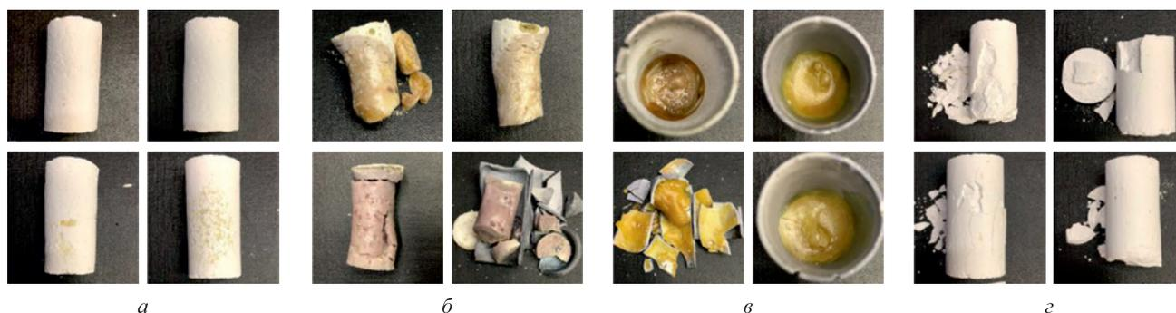
Рис. 1. Внешний вид термообработанных брикетов: а – спеченные; б – оплавленные; в – расплавившиеся; г – разрушившиеся/треснувшие
