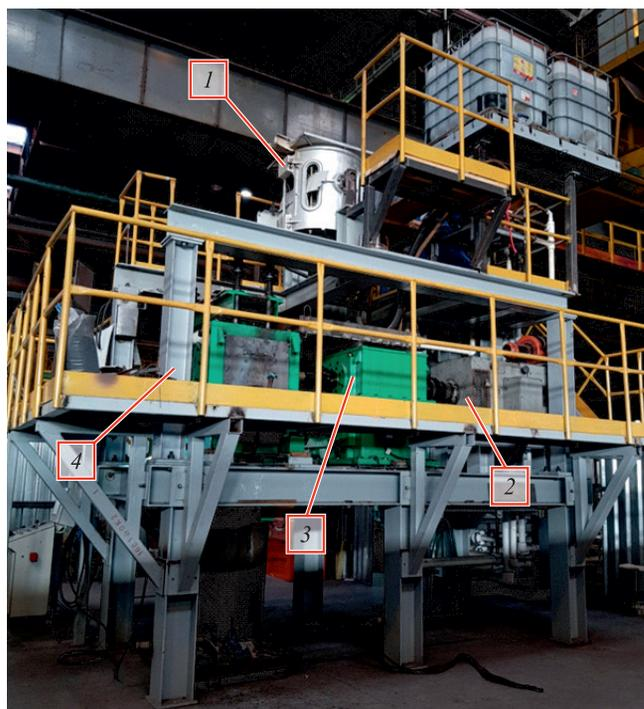
Рис. 1. Установка непрерывного литья и деформации:
