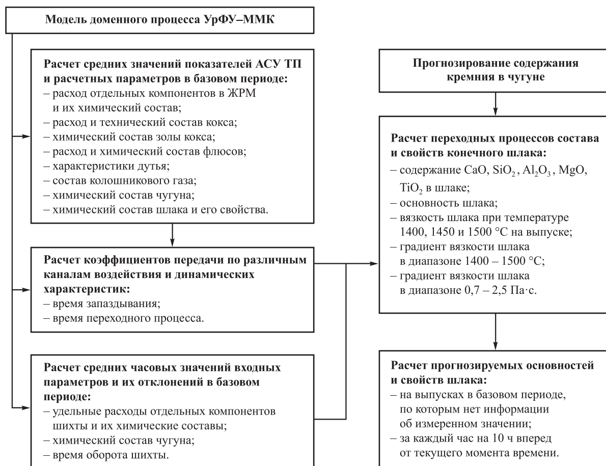
Рис. 1. Схема алгоритма прогнозирования состава и свойств конечного шлака
