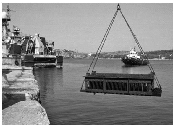
Рис. 3. Натурные испытания при погружении образцов в морскую воду с использованием кассеты
