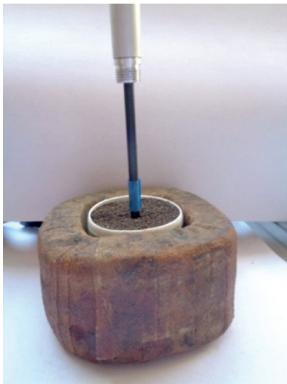
Рис. 1. Измерение индукции B_{ic} в центре образца дроби
