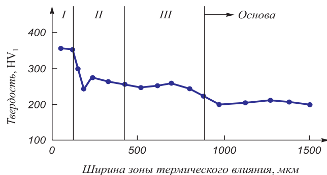
Рис. 7. График изменения твердости по ширине зоны термического влияния
