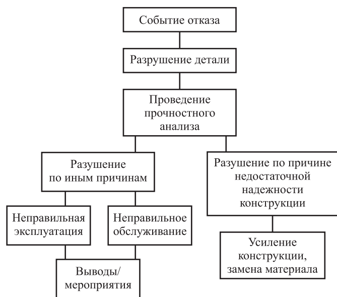
Рис. 2. Схема расследования отказа оборудования по причине разрушения детали
