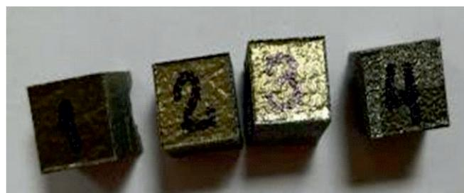
Рис. 5. Вид образцов на основе системы Fe–Cr–Co
