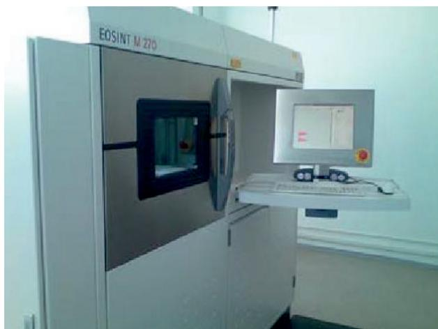
Рис. 4. Установка для прямого лазерного спекания металлов
