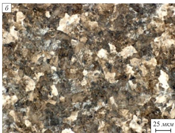
Рис. 2. Структура стали R350LHT после непрерывного охлаждения со скоростью 0,1 °C/s (а) и 1 °C/s (б)
