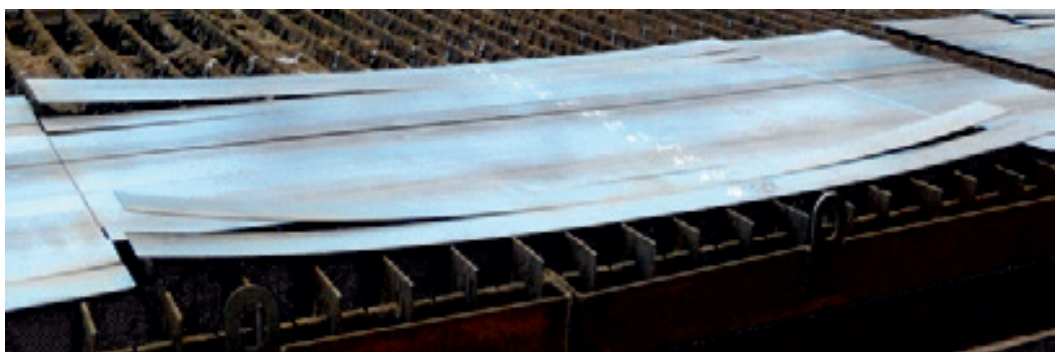
Рис. 2. Деформация листа после плазменной резки
