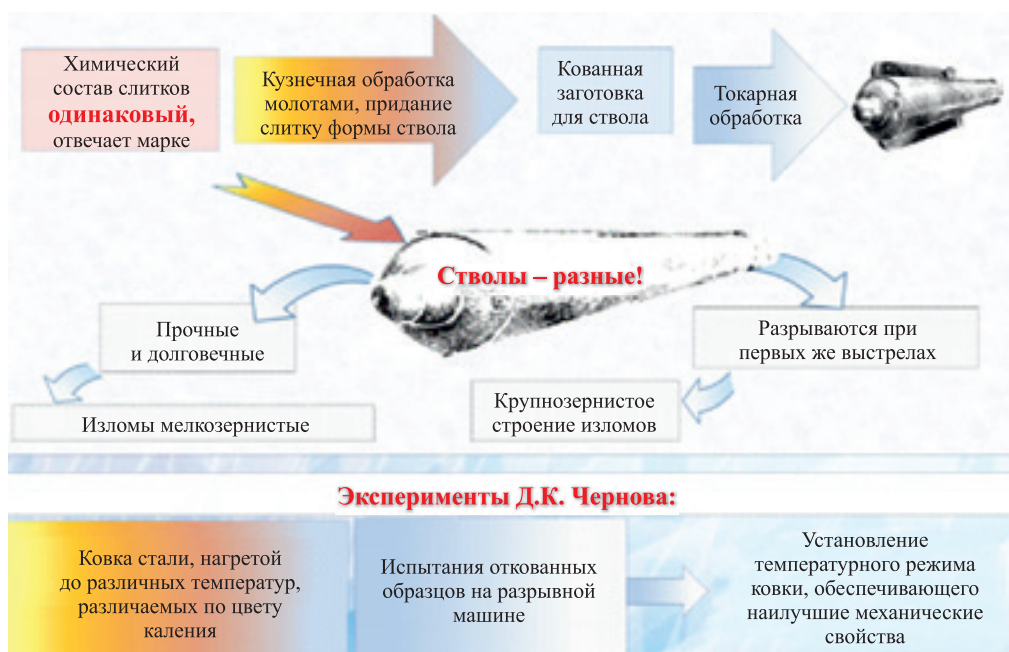
Рис. 2. Изучение причин разрыва пушечных стволов
