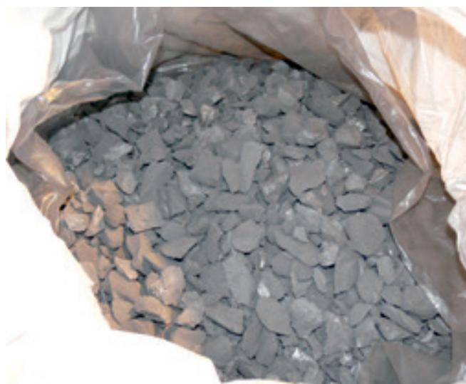
Рис. 5. Фракционированный нитрид феррохрома марки ФХН10
