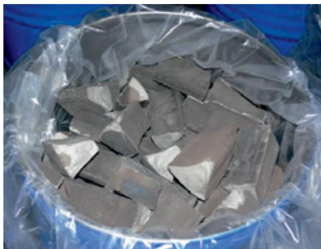
Рис. 4. Промышленные образцы нитрида феррованадия FERVANIT® марки ФВ45Н9
