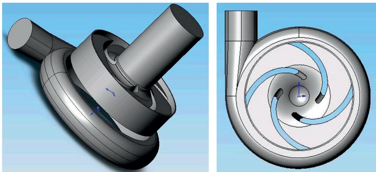
Рис. 1. Геометрическая модель проточной части насоса Гр 8
