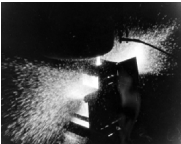
Рис. 2. Обдув чугуна встречными струями
