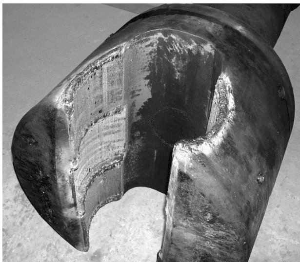
Рис. 6. Универсальный шпиндель прокатного стана с наплавкой
