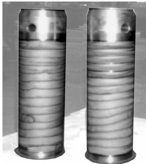
Рис. 7. Пальцы ковша экскаватора с плазменной закалкой
