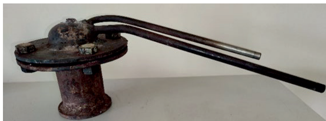
Рис. 1. Лабораторный реактор для исследования процессов окисления масла замасленной прокатной окалины
