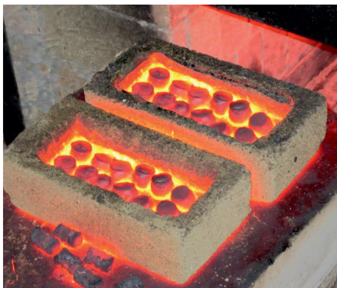
Рис. 5. Рудно-угольные брикеты в процессе металлизации в керамических поддонах
