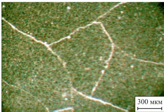
**Рис. 1.** Трещины на поверхности зоны лазерной обработки (сплав ВК8) при плотности энергии 2,0 Дж/мм<sup>2</sup>, кратности обработки 10
