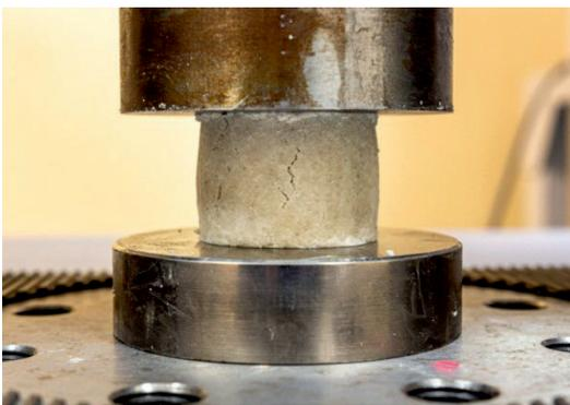
Рис. 3. Размещение экспериментального цилиндрического образца в тестовой машине при испытании на сжатие
