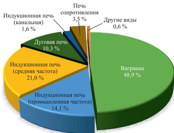
Рис. 10. Распределение литья в Беларуси по методу плавки
