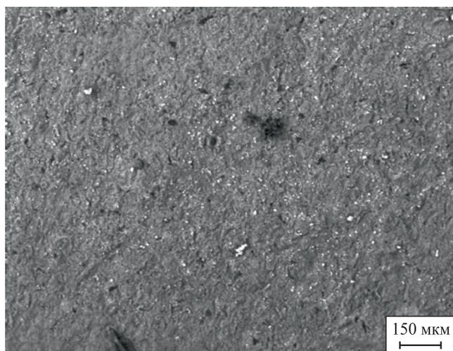
Рис. 1. Микрофотография поверхности образца лопатки после фторирования и восстановления водородом
